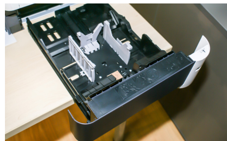
Szuflada podajnika papieru z regulowanymi przewodnikami pozwalającymi dopasować odpowiedni rozmiar nośnika (A4, A5, różnego typu koperty itd.) w zależności od oczekiwanych rezultatów druku. To tutaj zaczyna się droga kartki papieru w drukarce.
