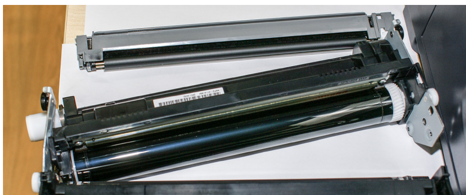
Bliższy element to bęben drukarki (w tym przypadku charakterystyczny wygląd wynika z zastosowania powłoki ceramicznej stanowiącej patent japońskiej firmy Kyocera).
